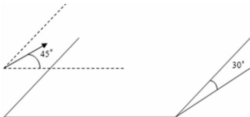
Площадка клинообразной формы установлена под углом  $30^\circ$  с горизонтом. Параллельно наклонной поверхности площадки под углом  $45^\circ$  к ее ребру брошен мяч (см. рис.). В момент удара о наклонную поверхность мяч имел скорость  $V = 3\sqrt{7}$  м/с, направленную горизонтально. Мяч находился в полете \_\_\_\_ с. (Ответ введите с точностью до десятых;  $g$  – ускорение свободного падения – принять равным  $10 \text{ м/с}^2$ .)
