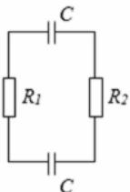
Два одинаковых плоских конденсатора емкостью  $C = 0,05 \text{ мКФ}$  имеют заряды  $q_0 = 270 \text{ мККл}$  (см. рис.). Расстояние между пластинами нижнего конденсатора быстро увеличивают в два раза. Если  $R_2 = 2R_1$ , то в итоге во втором резисторе выделится \_\_\_ мДж теплоты.
