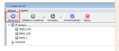
После запуска видеотрансляции необходимо проверить подключение камер в личном кабинете базового вуза на сайте <u>i-exam.ru</u> в разделе «Аудитории» (в столбце «Включена» должен быть установлен статус «Да»).
